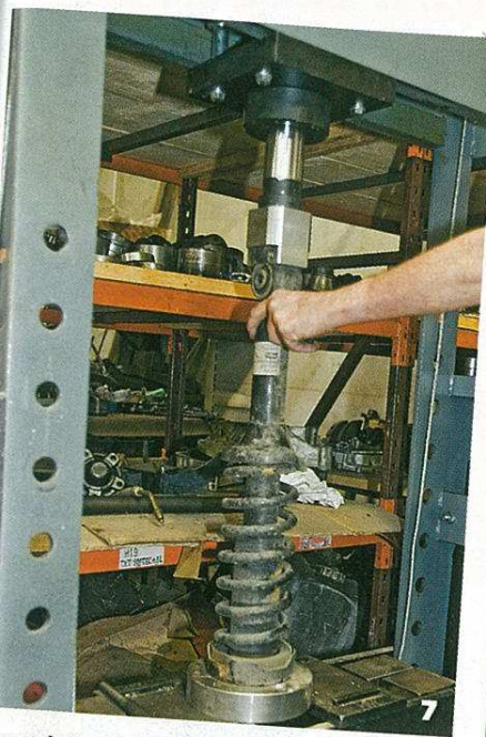
Deux solutions pour découpler le duo amortisseur/ressort. Dominique Totain, le boss de Service insiste sur les risques de manipuler des ressorts comprimés d'un combiné. La première option, professionnelle et recommandée, est celle où l'on place l'ensemble, tête en bas, dans la presse. On comprime le tout de façon à pouvoir desserrer l'écrou de tête d'amortisseur. Il reste alors qu'à décompresser lentement le tout pour retirer le ressort.
