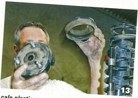
Pour réinstaller le tout, mêmes démarches : option presse ou griffe. Nous ne présenterons que l'option presse ici, mais le principe avec les griffes est identique. Le but étant de compresser le ressort. Notez tout de même que les ressort King Springs sont tarés plus raides que ceux d'origine, avec leur fil plus épais.
