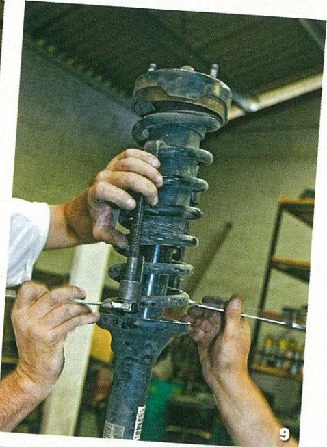
Alternative, la méthode du mécanicien bricoleur, présentée ici pour nous, mais encore une fois, Dominique insiste sur les dangers potentiels de manipuler des ressorts tenus par des griffes : à la moindre mauvaise manipulation, ça peut faire mal ! Avec deux griffes standards, serrez les écrous qui compressent l'ensemble. Idéalement, faites-vous aider afin de visser des deux cotés simultanément.
