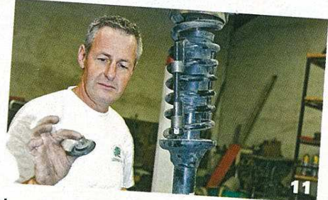
Le ressort comprimé, on peut alors déposer l'écrou de tête d'amortisseur (21 mm) et sa rondelle.
