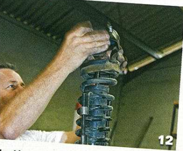
On dépose la coupelle de support et sa cale plastique.
