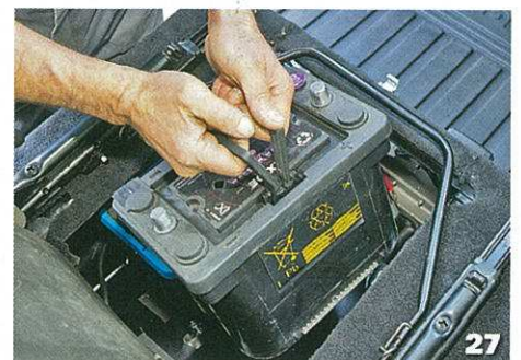
Boulonner le tout en passant les vis fournies sous la moquette si votre Defender en dispose. Vous pouvez utiliser les crochets d'origine pour plaquer le câblage contre la cloison.
