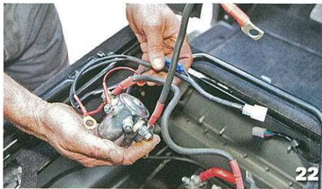
... l'installation de la bobine du coupleur.
