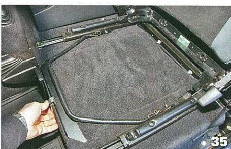
Remplacez la platine, la moquette et l'assise du siège et réalisez un essai roulant. Vous pouvez ensuite remettre en place le cric à sur son support d'origine. Il vous reste alors du volume pour un à deux bidons d'huile. Vous devrez cependant replacer la manivelle du cric et la cale de roue sous le siège passager. Vous voilà prêt pour affronter les pistes l'esprit tranquille.
