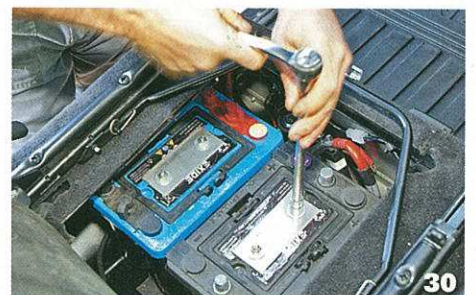
Boulonnez le tout en vissant par le haut et en maintenant les écrous sous la caisse, idéalement assisté d'une personne.
