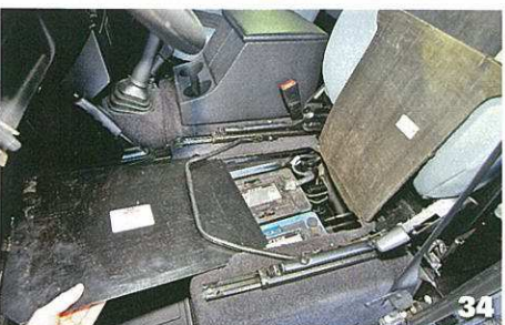
Remplacez la platine, la moquette et l'assise du siège et réalisez un essai roulant. Vous pouvez ensuite remettre en place le cric à sur son support d'origine. Il vous reste alors du volume pour un à deux bidons d'huile. Vous devrez cependant replacer la manivelle du cric et la cale de roue sous le siège passager. Vous voilà prêt pour affronter les pistes l'esprit tranquille.
