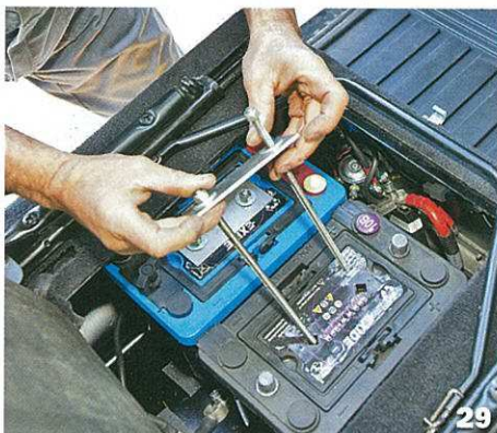
Installez ensuite des deux batteries, l'une contre l'autre.
