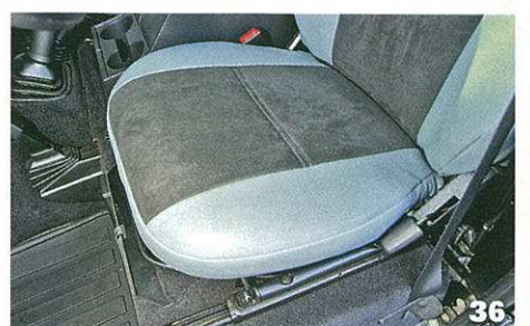
Remplacez la platine, la moquette et l'assise du siège et réalisez un essai roulant. Vous pouvez ensuite remettre en place le cric à sur son support d'origine. Il vous reste alors du volume pour un à deux bidons d'huile. Vous devrez cependant replacer la manivelle du cric et la cale de roue sous le siège passager. Vous voilà prêt pour affronter les pistes l'esprit tranquille.
