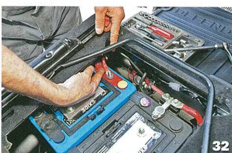
Branchez le "positif" de la seconde batterie avant de passer à celui de la principale, puis d'installer les "neutres".
