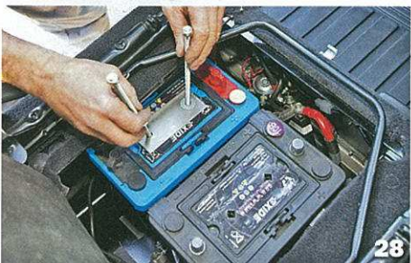
Mettez les fixations en place avec la visserie fournie.
