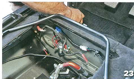
Boulonner le tout en passant les vis fournies sous la moquette si votre Defender en dispose. Vous pouvez utiliser les crochets d'origine pour plaquer le câblage contre la cloison.
